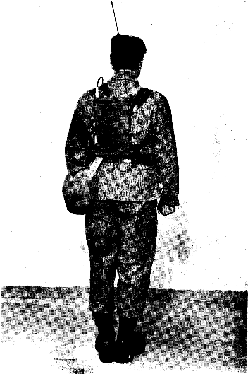
Obr. 7 Rádiová stanice v poloze "na zádech" (obsluhovaná důstojníkem) - pohled zezadu
